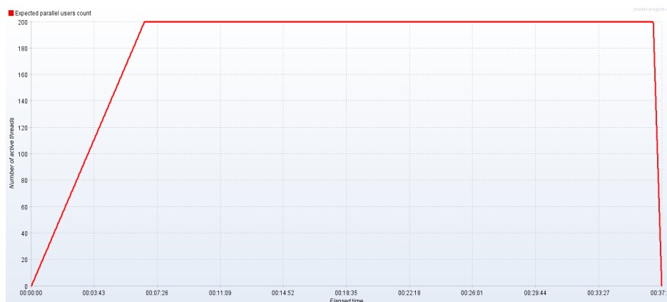
Abbildung 2: Aufbau des Performancetests mit 200 Usern auf einem Streamingserver mittels der „Ultimate Thread Group“ in JMeter
